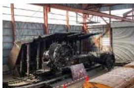
石炭層を削り取るドラムカッター(採炭機械)
